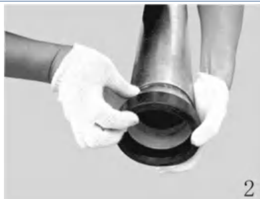
钢管卡箍安装过程图
