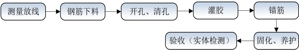
植筋施工流程
