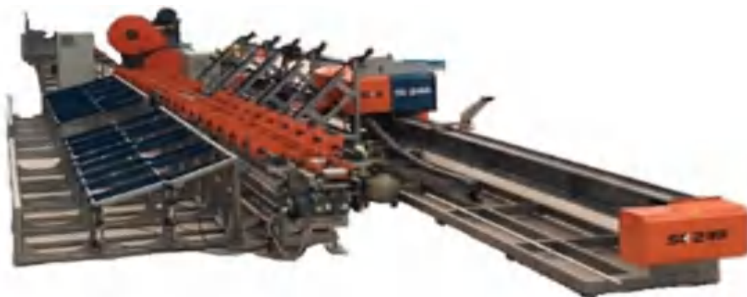
智能钢筋剪切、弯曲数控设备
