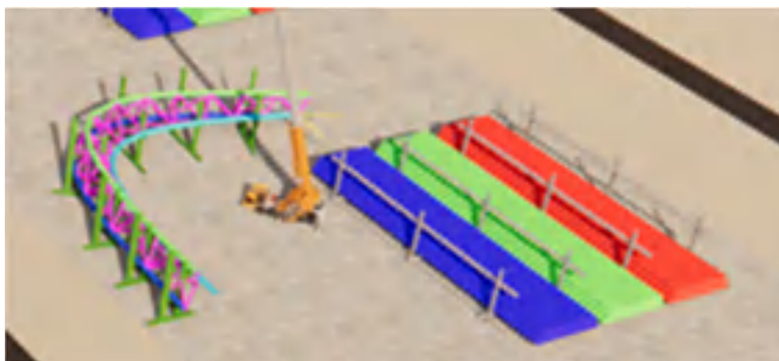
体育场罩棚桁架胎架示意图
