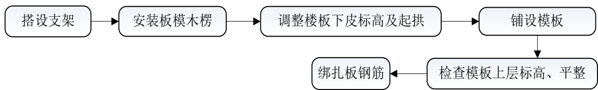
板模板安装工艺流程图
