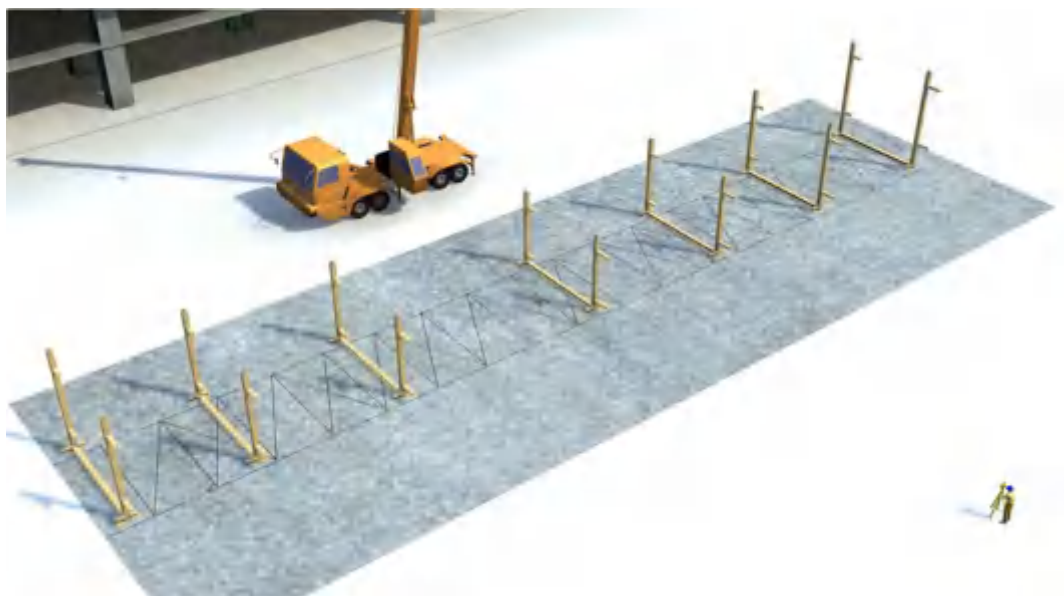
游泳馆钢桁架胎具平面布置图
