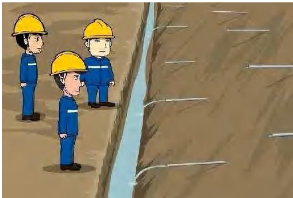
基坑壁导水管设置示意图
