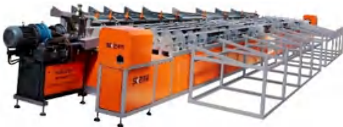
智能钢筋锯切、套丝、打磨设备
