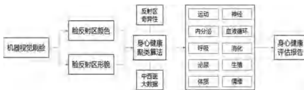
健康筛查机器人应用的技术原理
