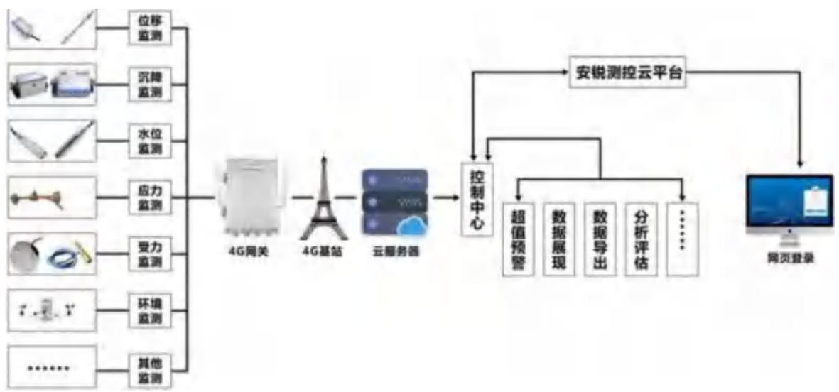
深基坑支护监测系统
