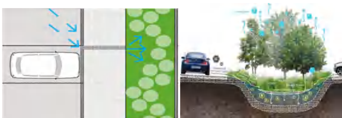
多余的雨水径流通过雨水沟进入下凹海绵设施示意图
