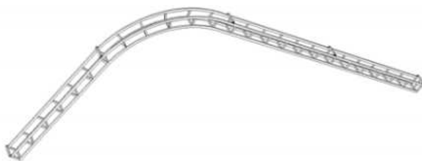
屋面板吊装骨架图
