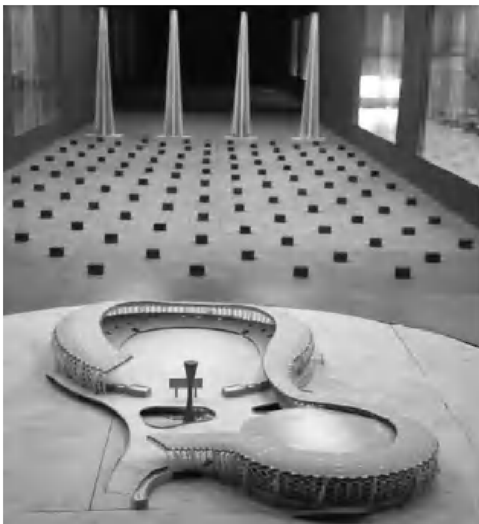
类似项目体育中心风洞试验照片
