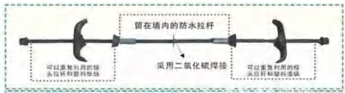
止水对拉螺栓示意图
