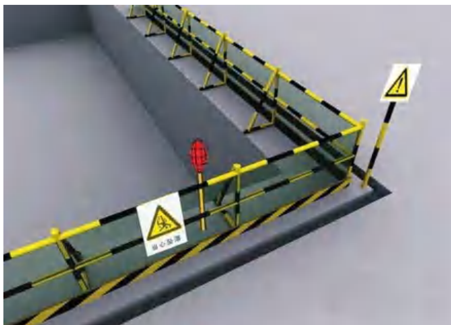
深基坑临边防护示意图
