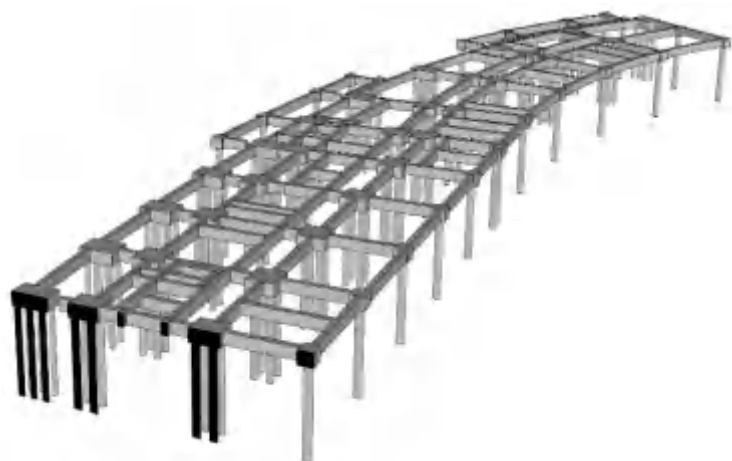
步骤一：基础承台地梁施工完成
