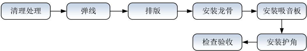
吸音板墙面施工工艺流程
