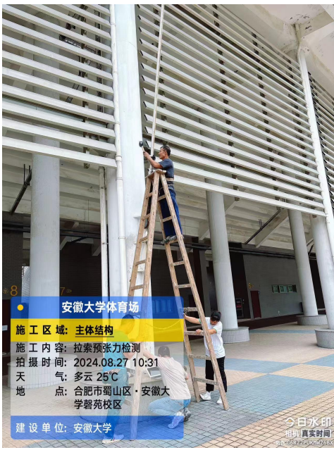
无线索力测试系统检测索力-2
