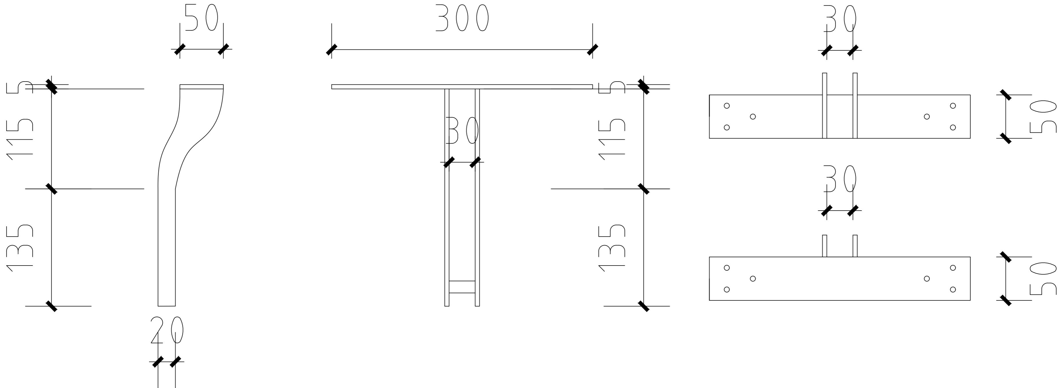
说明：杆件均为304不锈钢定制，激光切割，激光焊接。焊接处满焊，美化处理。
