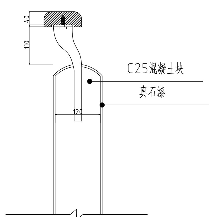
说明: 扶手为瓷态竹木定制扶手, 尺寸按照图纸尺寸定制, 扶手相接处, 缝宽应考虑膨胀系数。
