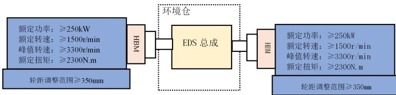
单边调整范围为 $\geq 350\text{mm}$ ，采用电动调节，可 XYZ 三轴调节（调节范围均 $\geq 200\text{mm}$ ），带有刻度指示。
